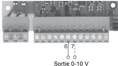
Fig. 5 Sortie analogique
