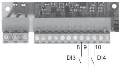
Fig. 6 Digitala ingångar DI3 och DI4
