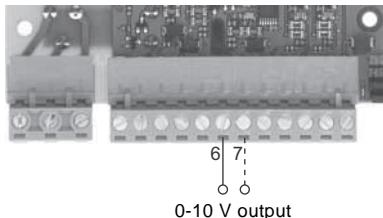
Fig. 5 Analog output
