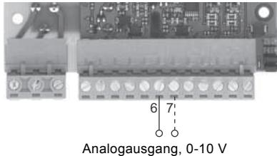
Abb. 5 Analogausgang
