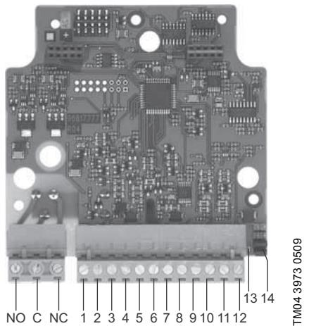
Рис. 1 Модуль IO
