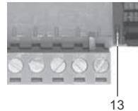
Fig. 8 Strømforsyningslysdiode
