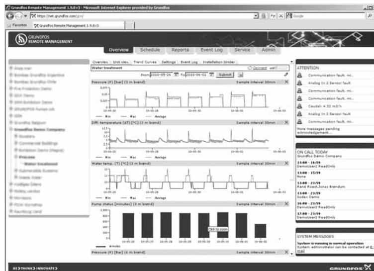
**Fig. 26** Exemple d'affichage graphique des données reçues à partir des capteurs surveillés
