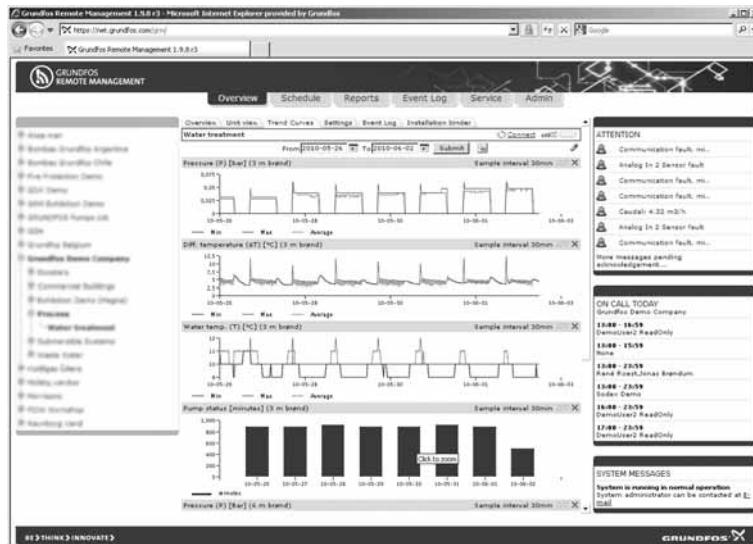
Рис. 26 Пример графического изображения данных от отслеживаемых датчиков
