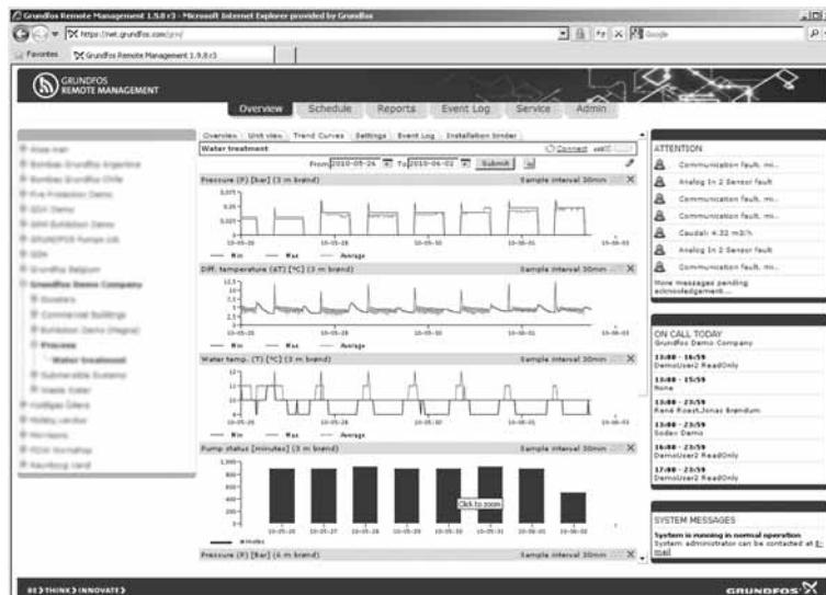
**Fig. 26** Ejemplo de un display gráfico de datos para sensores monitorizados
