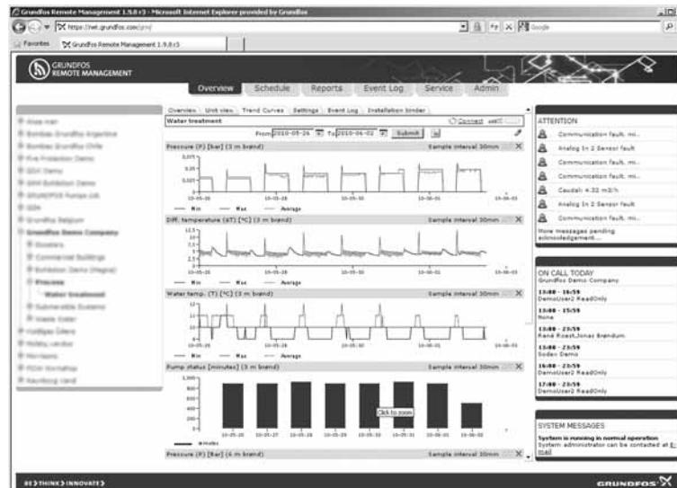
**Abb. 26** Beispiel für die grafische Darstellung der von den Sensoren gelieferten Daten
