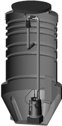
Fig. 4 Poço com bomba sem suporte
