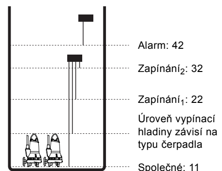
Obr. 31 Elektrody v čerpací jímce se dvěma čerpadly
