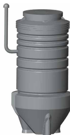
Obr. 15 Čerpací jímka s odvětrávací trubkou
