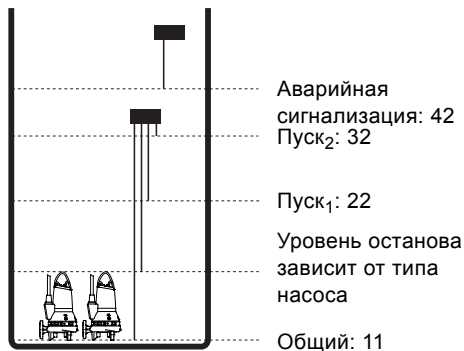
Рис. 31 Электроды в канализационном колодце, оборудованном двумя насосами
