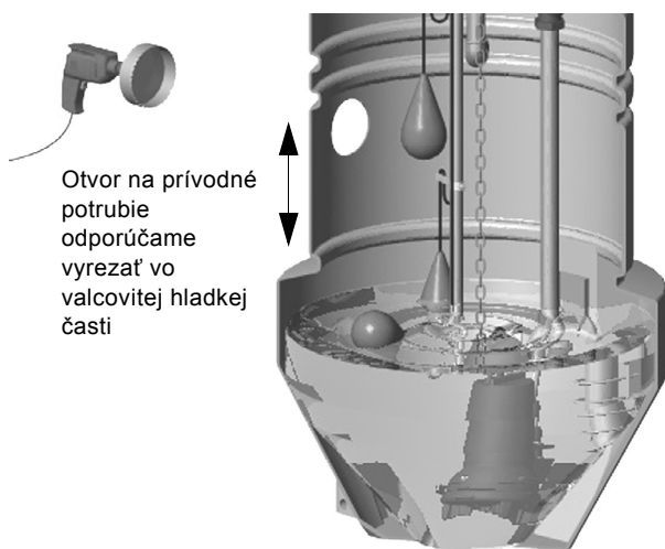
Obr. 21 Vŕtanie vstupného otvoru, \varnothing 400-1000 mm
