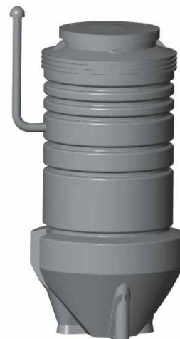
Рис. 15 Канализационный колодец с вентиляционным трубопроводом
