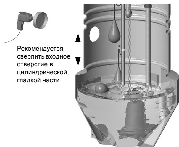
Рис. 21 Обработка отверстия под подводящий трубопровод, Ø400-1000 мм
