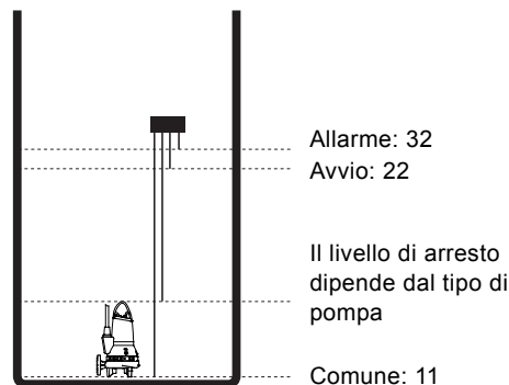
Fig. 30 elettrodi in un pozzetto con una pompa
