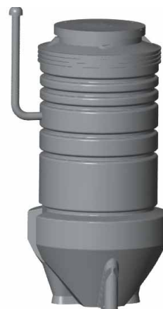
Fig. 15 Poço com tubagem de ventilação
