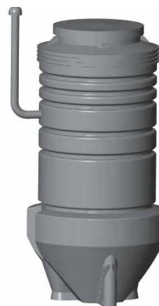
Rys. 15 Zbiornik z rurą wentylacyjną
