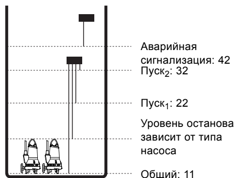
Рис. 31 Электроды в канализационном колодце, оборудованном двумя насосами
