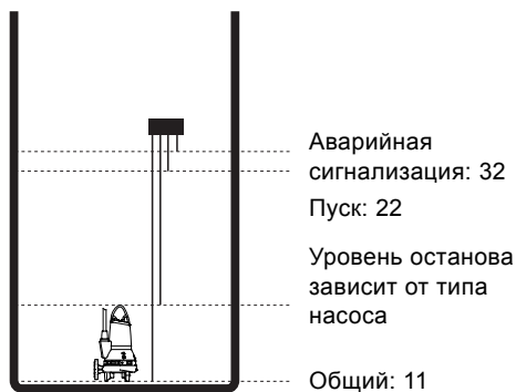
Рис. 30 Электроды в канализационном колодце, оборудованном одним насосом
