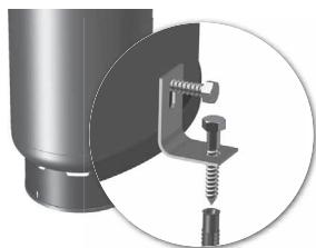
**Fig. 3** Instalarea rezervorului cu bază de oțel
