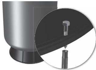
**Abb. 4** Befestigen eines Behälters mit Standfuß aus Kunststoff
