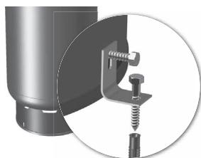
**Fig. 3** Montering af beholder med fodstykke af stål
