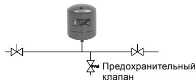
Рис. 9 Предохранительный клапан
