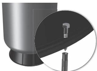
Rys. 4 Montaż zbiornika z podstawą z tworzywa sztucznego
