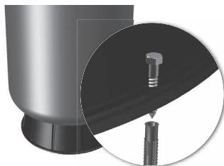
**Fig. 4** Montering af beholder med fodstykke af plast
