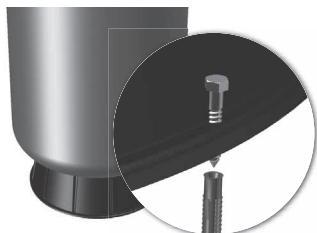
**Fig. 4** Instalarea rezervorului cu bază de plastic
