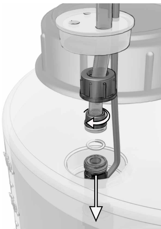
Fig. 9 Indføring af bundventilen
