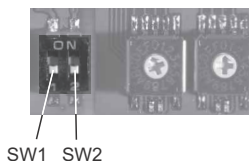
Obr. 5 Vypínání a zapínání zakončovacích odporníků
