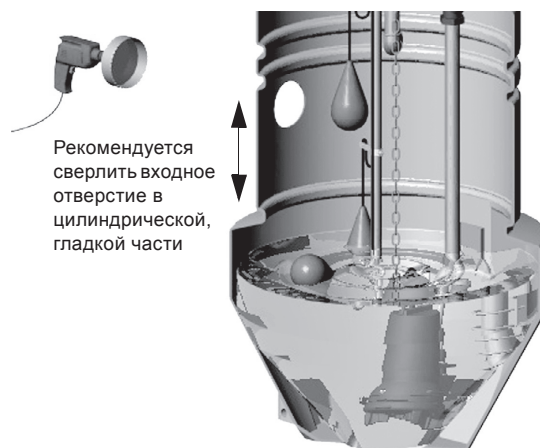
Рис. 16 Отверстие под подводящий трубопровод, Ø400-1000 мм
