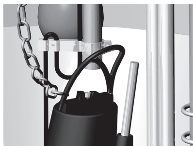
Рис. 20 Подъемная цепь, прикрепленная к насосу
