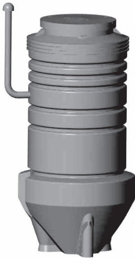
Рис. 11 Резервуар с вентиляционным трубопроводом
