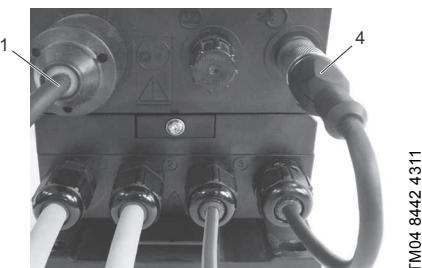
**Fig. 5** Collegamento della E-Box alla DDA
