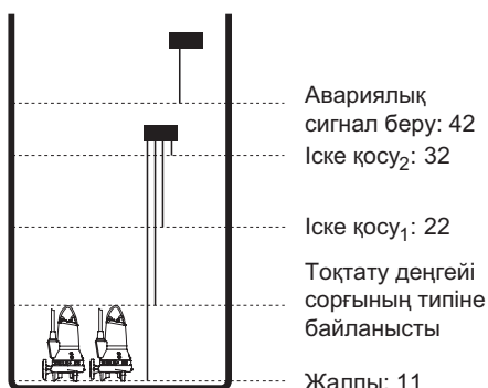
29-сур. Екі сорғымен жабдықталған кәріздік құдықтағы электродтар
