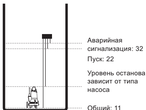
Рис. 28. Электроды в канализационном колодце, оборудованном одним насосом
