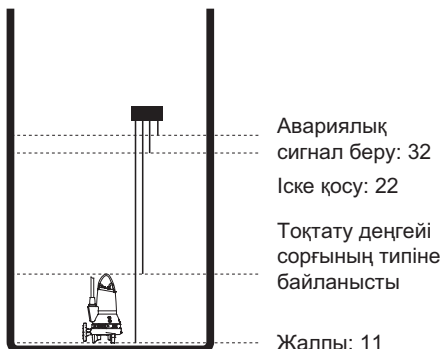
28-сур. Бір сорғымен жабдықталған кәріздік құдықтағы электродтар
