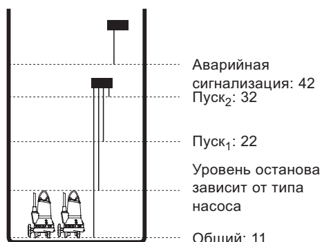
Рис. 29. Электроды в канализационном колодце, оборудованном двумя насосами
