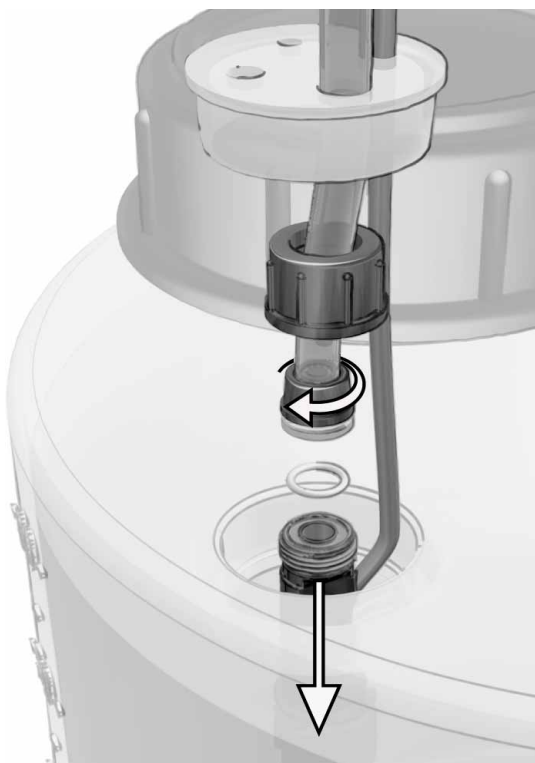
Рис. 9 Установка приёмного клапана
