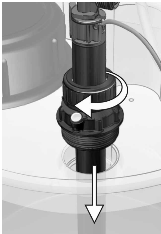
Рис. 8 Установка всасывающей линии
