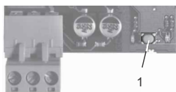
Рис. 3 Кнопка Service pin
