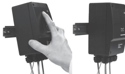
Fig. 3 Unidade CIU na calha DIN
